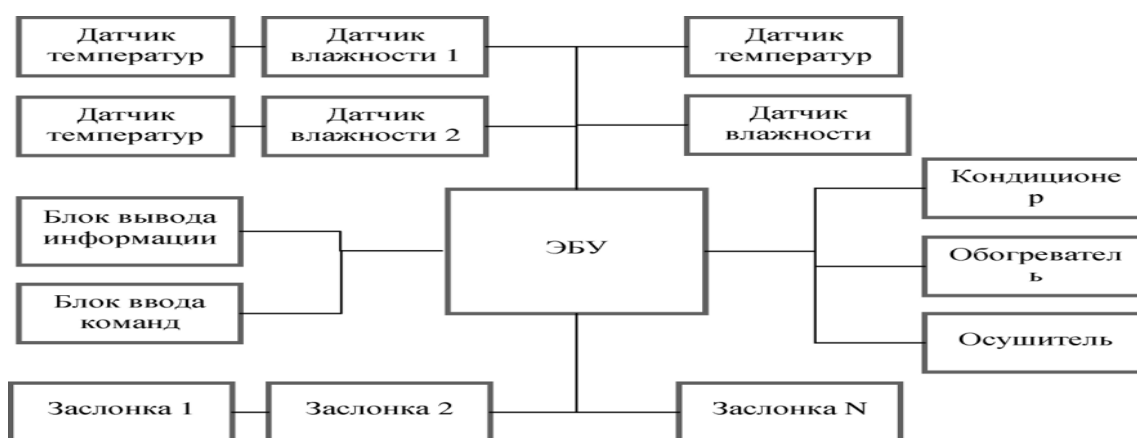
Схема взаимодействия устройств АСУ выращивания тропических растений.
